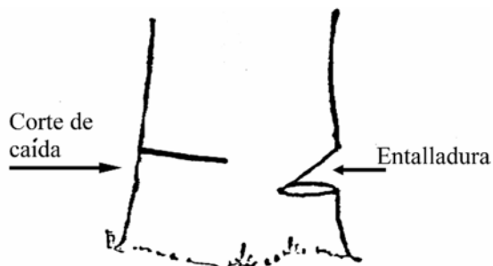
FIGURA 16. VISTA DE LA ENTALLADURA, CORTE DE CAIDA Y BISAGRA EN APEO DIRIGIDO
