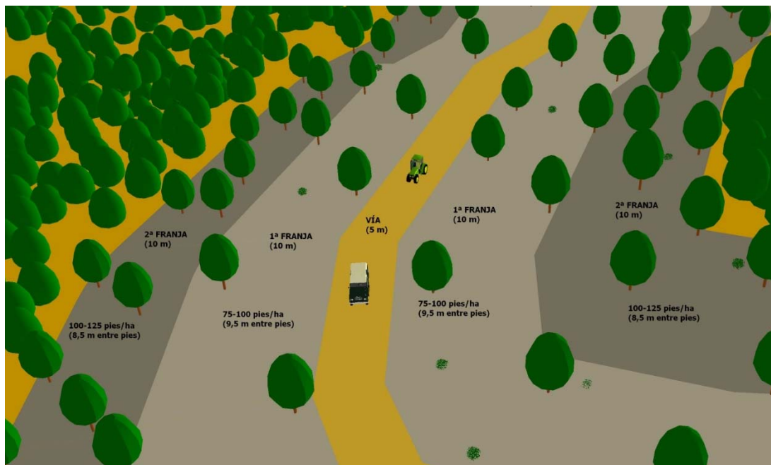
FIGURA 18. ESQUEMA DE DISEÑO DE FAJA AUXILIAR DE PISTA
